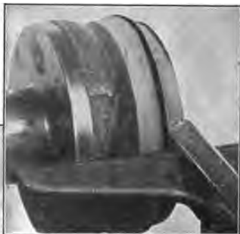
Fig. 125. Turning Edge of Rosette.
